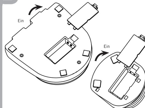
An der Unterseite des Gerätes eine 9-Volt-Batterie einlegen. Zum Einschalten des Gerätes den Lautstärkenregler drehen.
