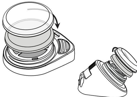
Das Oberteil des farbigen Tasters fest nach links drehen und abnehmen. Zum Anbringen der neuen Farbe den Deckel bis zum Anschlag nach rechts drehen.
