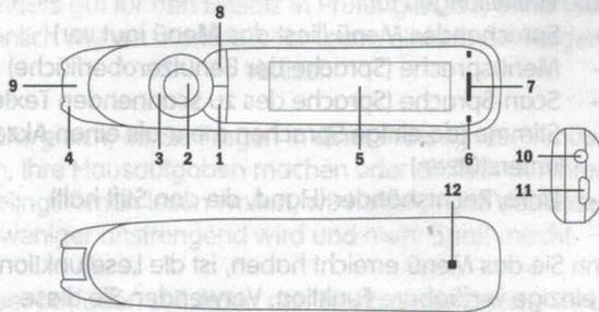
1. Ein-/Ausschalttaste und Zurück-Taste: Drücken Sie 3 Sekunden lang, um das Gerät einzuschalten. Kurz drücken, um Vorgänge auf der Benutzeroberfläche abzubrechen.
