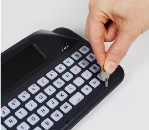
3. Wiederholen Sie Schritt 2 mit dem linken und mittleren Hebelpunkt, bis die Vorderseite der Tastenführung vollständig vom Lightwriter gelöst ist. Wenn sie noch etwas fest sitzt, benutzen Sie das Wechselwerkzeug erneut an jedem der Hebelpunkte.
