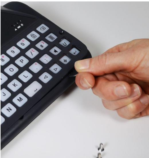
4. Ist die Tastenführung gelöst, greifen Sie diese vorsichtig an der Unterkante und ziehen sie nach oben und nach vorn von Ihrem Lightwriter weg. Sollte sich beim Entfernen der Tastenführung Tasten lösen, drücken Sie diese einfach wieder auf ihren Platz auf der Gummimatte. Achten Sie auf ihren sicheren Sitz.
