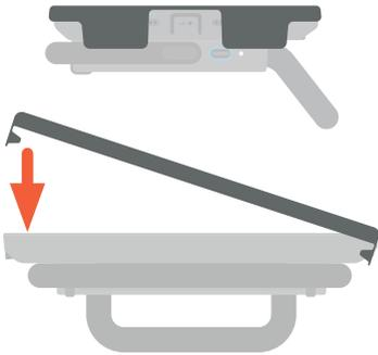
Legen Sie die rechte Seite des Rahmens mit den beiden Clips über die rechte Seite Ihres Geräts und drücken Sie die linke Seite nach unten, um den Rahmen zu befestigen. Möglicherweise müssen Sie den linken Clip nach außen ziehen, damit er richtig sitzt.
