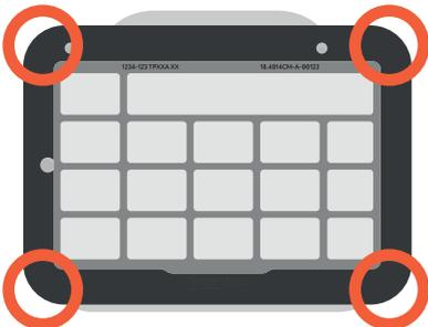
Drücken Sie alle vier Ecken fest an, um sicherzustellen, dass die Fingerführung gut gesichert ist.
