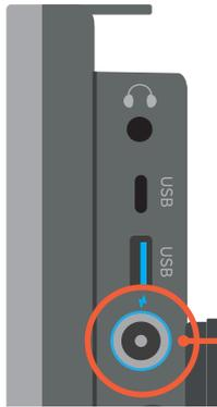
Zum Aufladen stecken Sie das Netzkabel in den entsprechenden Port auf der linken Seite des Geräts. Wenn Ihr Grid Pad lädt, leuchtet der Ladeindikator **weiß**.
