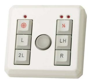
Der FingerButton ist ein vollwertiger Ersatz einer herkömmlichen Computermaus, alle Mausfunktionen (Linke / Rechte Maustaste, Doppelklick, Markierfunktion, Radfunktion) können mit dem JoyButton durchgeführt werden. Kontrollleuchten zeigen den jeweiligen Rastzustand der Tasten an.
