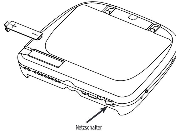
Vier AA-Batterien (Mignonzellen) in das Gerät einlegen (siehe Abbildung). Der Netzschalter befindet sich an der Rückseite des Gerätes.
