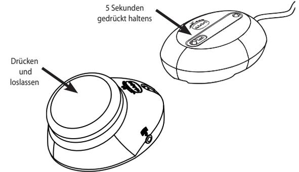
1. Halten Sie bei eingeschaltetem Funksender und -empfänger den „Test“- oder „Mode“ (Modus)-Knopf des Empfängers gedrückt, bis die Lampe grün leuchtet (ungefähr 5 Sekunden).
